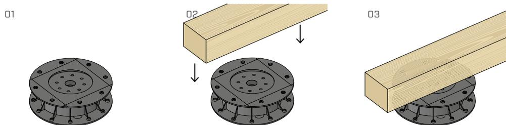
È possibile appoggiare semplicemente il listello al supporto SUP-S oppure fissarlo con viti KKF diametro 4,5 mm.
