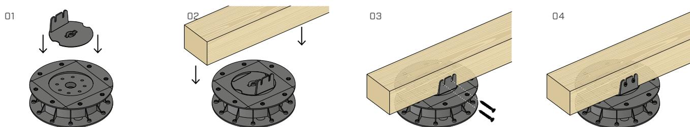
Posizionare la testina SUPSLHEAD1 sul supporto SUP-S e fissare il listello con viti KKF diametro 4,5 mm.
