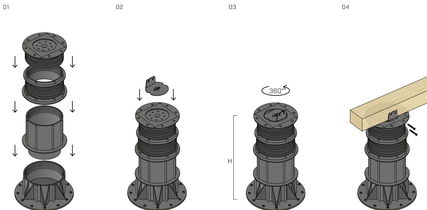
Aggiungere la prolunga SUPLEXT100 al supporto SUP-L e successivamente posizionare la testina SUPSLHEAD1. Regolare l'altezza in base alle esigenze e fissare il listello lateralmente con viti KKF diametro 4,5 mm.
