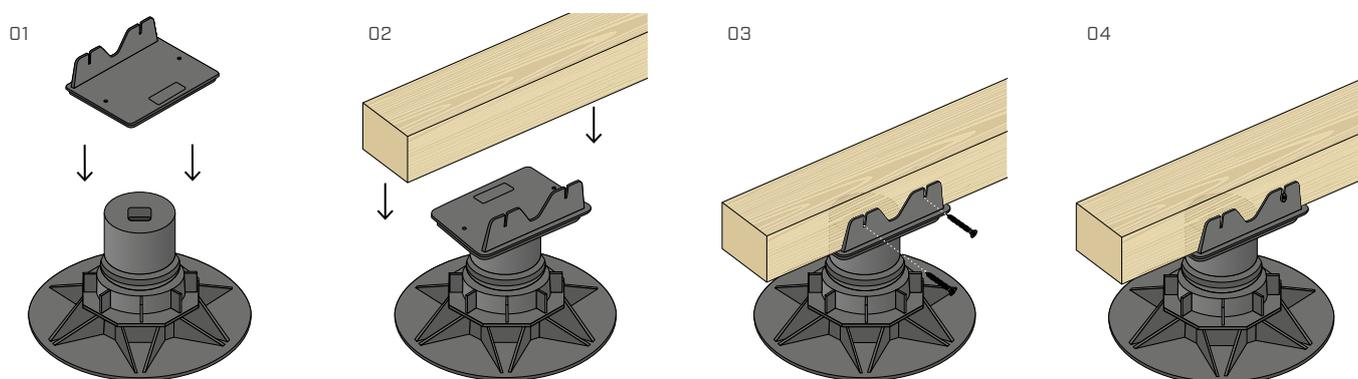
Posizionare la testina SUPMHEAD2 sul supporto SUP-M e fissare il listello lateralmente con viti KKF diametro 4,5 mm.
