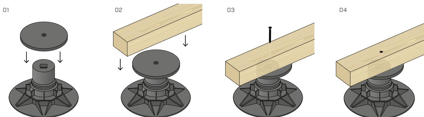
Posizionare la testina SUPMHEAD1 sul supporto SUP-M e fissare il listello con viti KKF diametro 4,5 mm.
