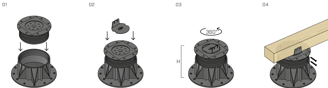
Posizionare la testina SUPSLHEAD1 sul supporto SUP-L , regolare l'altezza in base alle esigenze e fissare il listello lateralmente con viti KKF diametro 4,5 mm.
