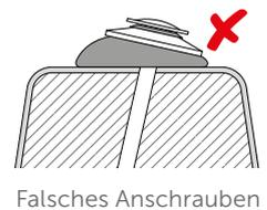
Falsches Anschrauben schräg zur Achse
