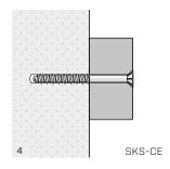
Sicherstellen, dass der Schraubenkopf vollkommen am Gegenstand anliegt, der befestigt werden soll
