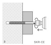
Den Gegenstand, der befestigt werden soll, positionieren und die Schraube mit einem Schlagschrauber anbringen
