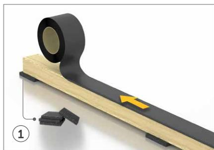
Die DECK BASE unter den Unterkonstruktionen (circa alle 50 cm) anbringen und diese mit dem DECK BAND UV abdecken.
