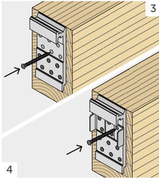
Platzieren Sie den Verbinder auf dem Holzbalken und befestigen Sie die ersten Schrauben. Wenn Sie LOCK STOP (optional) verwenden, positionieren Sie LOCK STOP und sichern Sie die restlichen Schrauben.
