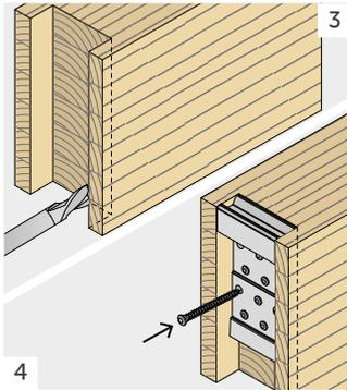
Führen Sie die vollständige Ausfräsung am Nebenträger aus. Platzieren Sie den Verbinder und befestigen Sie alle Schrauben.
