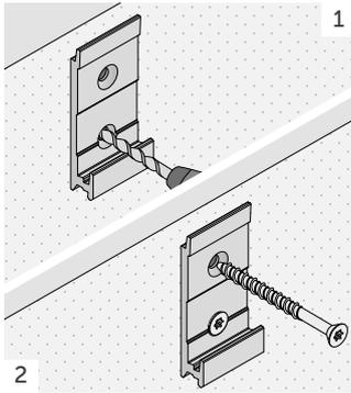
Platzieren Sie den Verbinder auf Beton und befestigen Sie die Anker gemäß den Montageanweisungen.
