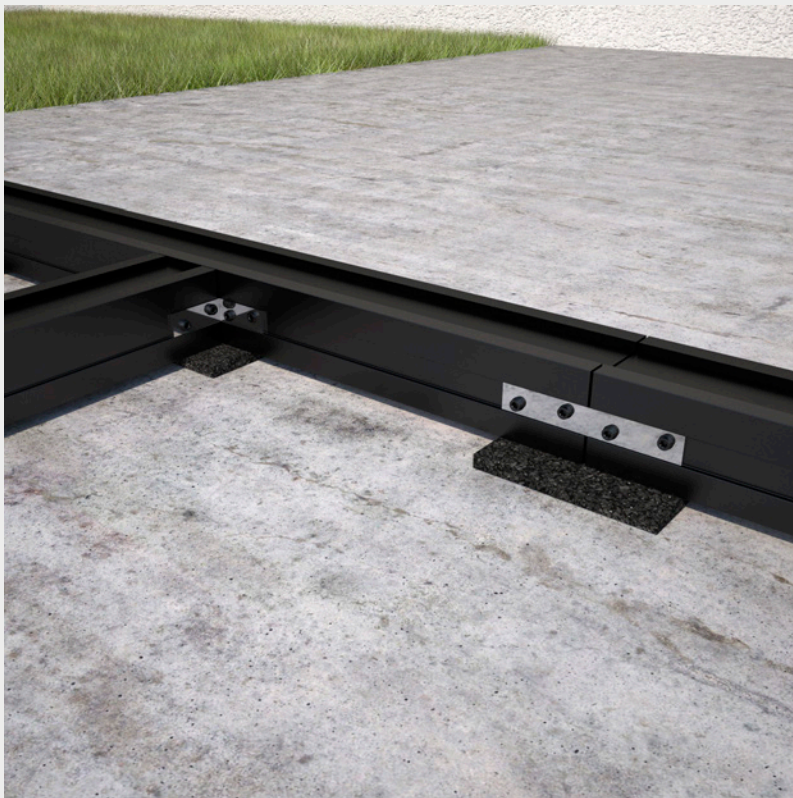
^ Stabilisierung der Profile ALUTERRA50 mit Edelstahlplättchen und KKA-Schrauben.
