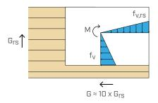
Momento de inercia polar de mitad inserto con respecto al baricentro, pesado sobre los módulos de corte de madera:
