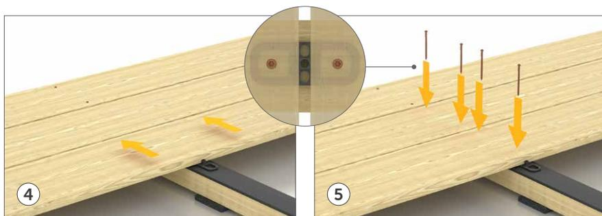
Positionner les lames suivantes en les posant sur les SNAP situés le long des liteaux. Serrer les trois lames à l'aide de la presse CRAB MINI, jusqu'à obtenir un écartement de 7 mm.
