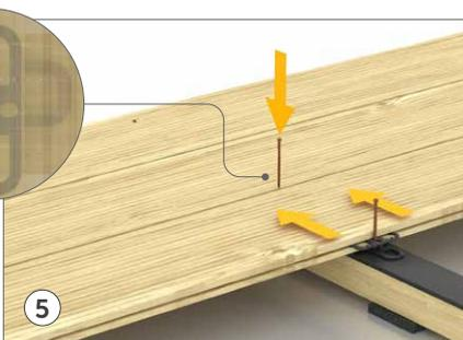
5 Positionner la lame suivante en l'insérant dans le connecteur SNAP. Serrer les lames à l'aide de la presse CRAB MINI jusqu'à obtenir un écartement d'au moins 7 mm entre les lames. Fixer les connecteurs en vissant les vis sur le liteau sous-jacent.
