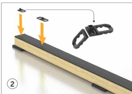
2 Rompre le SNAP au niveau des entailles prévues et le positionner à proximité du bord du liteau. Positionner les autres SNAP entiers tout au long du liteau.
