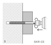
Positionner l'objet à fixer et installer la vis avec la visseuse à impulsions
