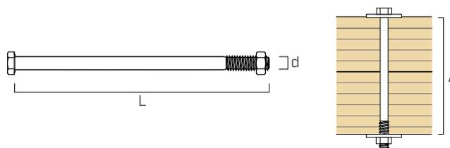
L'épaisseur maximale fixable A est calculée pour un écrou MUT934 et 2 rondelles ULS 440.
