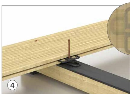
4 Posicionar o SNAP de modo a que o pescoço entre totalmente em contacto com o pescoço do outro SNAP posicionado por baixo da tábuas. Fixá-los, inserindo um parafuso MINI no orifício central do SNAP superior. Por enquanto, NÃO aparafusar.
