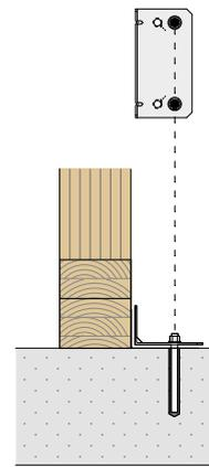
2 анкера, установленные в **НАРУЖНЫЕ ОТВЕРСТИЯ (OUT)**
